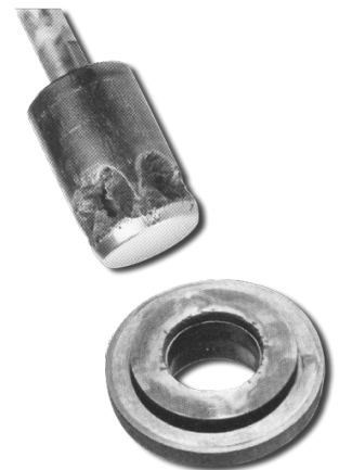
Deterioro en disco y asiento de una válvula tipo globo por cavitación y "flasheo"
